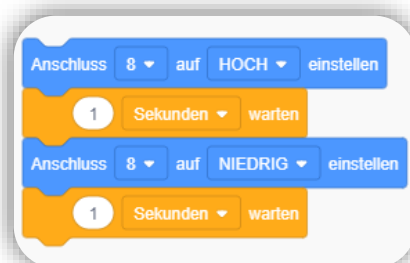
Abb. 13: Programmcode zum Einschalten einer LED
