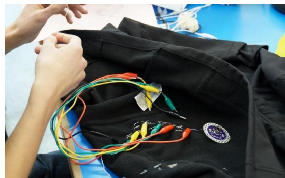
Abbildung 2: Innenleben einer Fahrradjacke mit Blinkern
